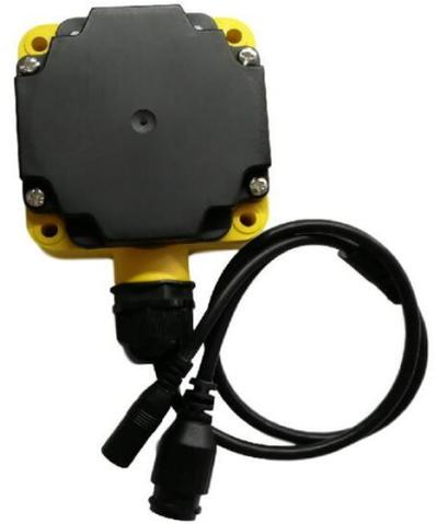
岳冉 FU109 工业超高频 RFID 读写器是一款工业级 RFID 读卡器，体积小巧，安装方便，防护等级高，读写性能优异。标配 RS232、RS485 通讯接口，选配 RJ45 接口，可配置成主动读的工作模式，读到标签主动往服务器发送数据。
